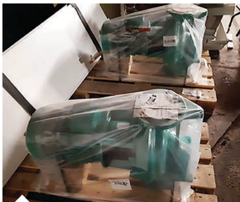
Pompy gorącej wody do centralnego ogrzewania gotowe do instalacji
